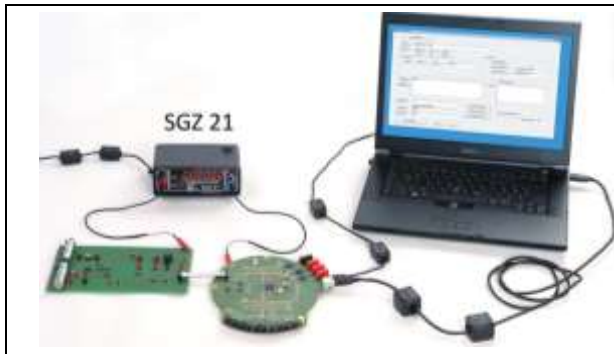
Bild 27: Einspeisen von Störstrom zweipolig über den Steckverbinder zweier Baugruppen. Die Kontaktierung erfolgt jeweils an Masse der Baugruppen.
