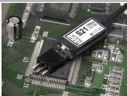
Bild 9: Sensor S21 über dreipolige Buchse im Prüfling angeschlossen, z.B. an einem IC
