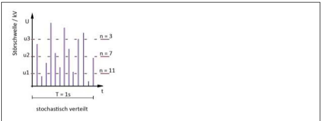
Bild 16: Die Impulse werden vom SGZ 21 fortlaufend und in ungeordneter Reihenfolge erzeugt.
