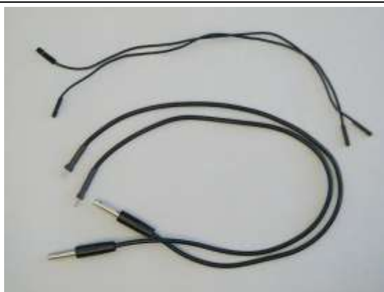
Bild 3: Generatorkabel (unten); 2 Verlängerungskabel (oben)
