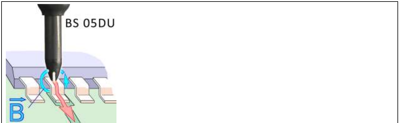
Bild 37: Zum Beaufschlagen kleiner Leiterschleifen eignet sich die Magnetfeldquelle BS 05DU.
